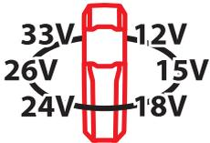
**Flessibilità:** COMPACTA può essere alimentata con un ampio range di alimentazione, 12-33Vac 50/60Hz e 15-35Vdc, rendendola utilizzabile in un larghissimo numero di installazioni. Inoltre, può essere collegata con tutte le centrali BFT che prevedono la gestione verificata delle sicurezze.
