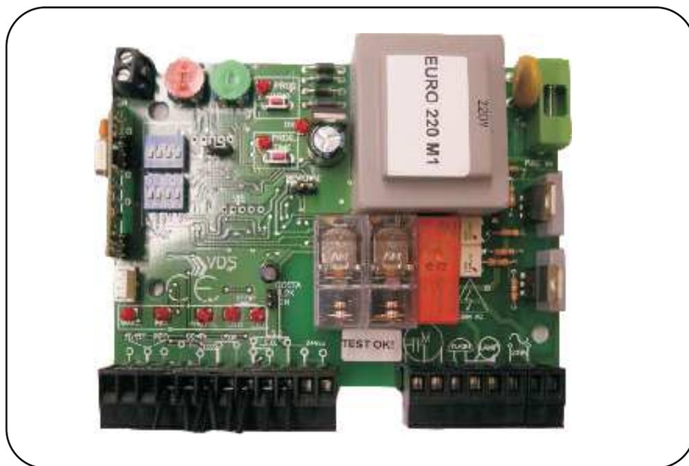
Apparecchiatura di comando 1 Motore 230Vac
