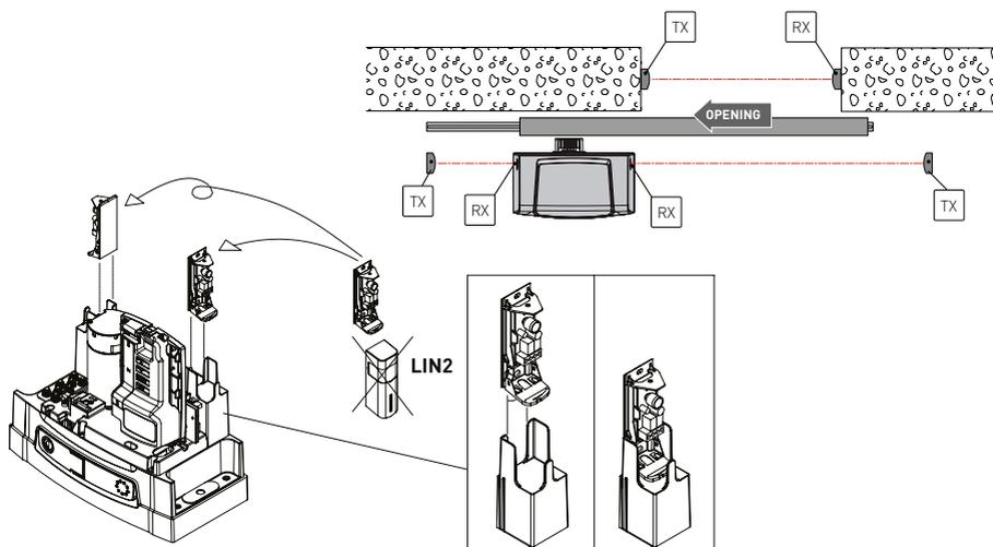
È possibile installare delle fotocellule aggiuntive all'interno del carter di Ditec NEOS, per la protezione sia del movimento di chiusura che del movimento di apertura, utilizzando la fotocellula LIN2.
