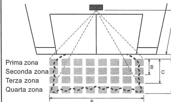
Una volta eseguita la regolazione, raccomandiamo di riaccendere il sensore e controllare in pratica la correttezza delle varie zone di rilevamento impostate.
